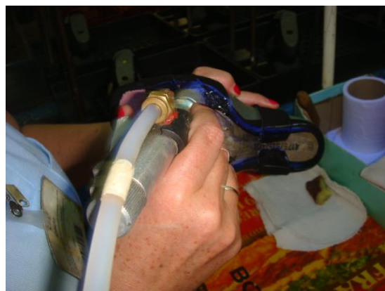
Aplicar adesivo com pistola pneumática
